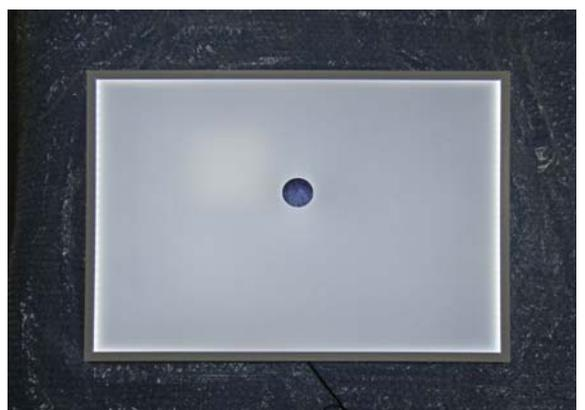
導光板の穴加工 検査用光源
